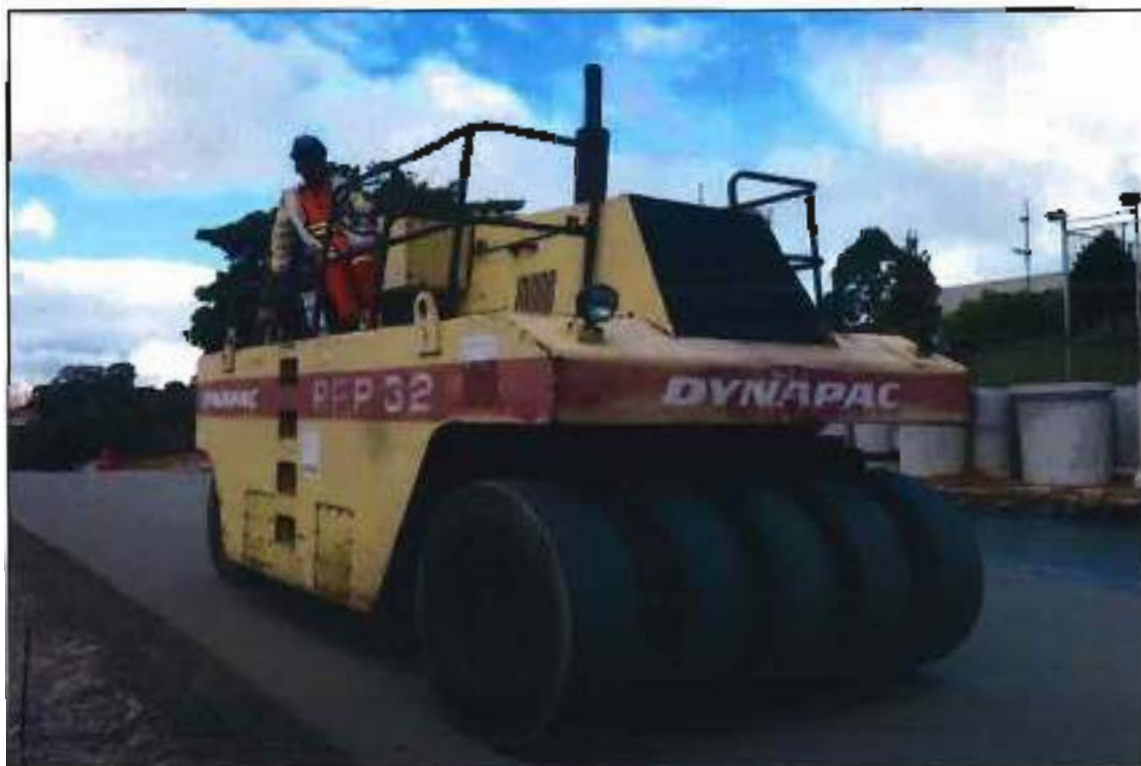
ITEM 2,144 - VISTA DO ROLO PROPULSOR DE PNEU MARCA: DYNAPAC MODELO: CP271 CHASSI/SERIE: 2362BR2036 PLACA: Sem placa
