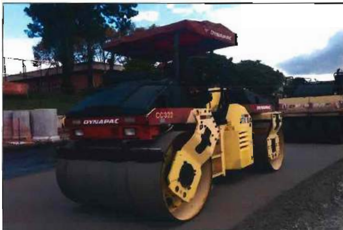
ITÊM 2,150 - VISTA DO ROLO COMPRESSOR TANDER MARCA: DYNAPAC MODELO: CC 322 CHASSI/SERIE: 62110391 PLACA: Sem placa
