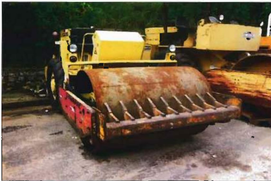
ITEM 2,147 - VISTA DO ROLO COMPRESSOR VIBRATORIO MARCA: DYNAPAC MODELO: CA 15 CHASSI/SERIE: 677B542 PLACA: Sem placa
