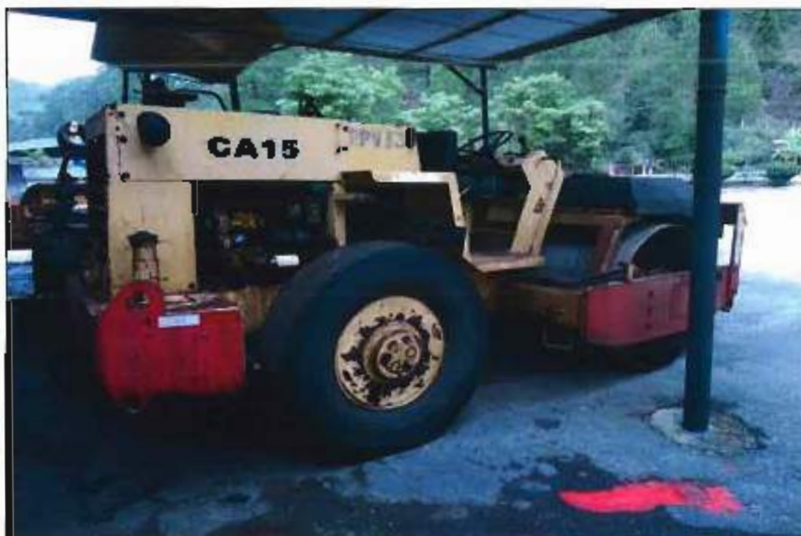
ITEM 2,148 VISTA DO ROLO COMPRESSOR VIBRATORIO MARCA: DYNAPAC MODELO: CA 15 CHASSI/SERIE: 677B687 PLACA: Sem placa
