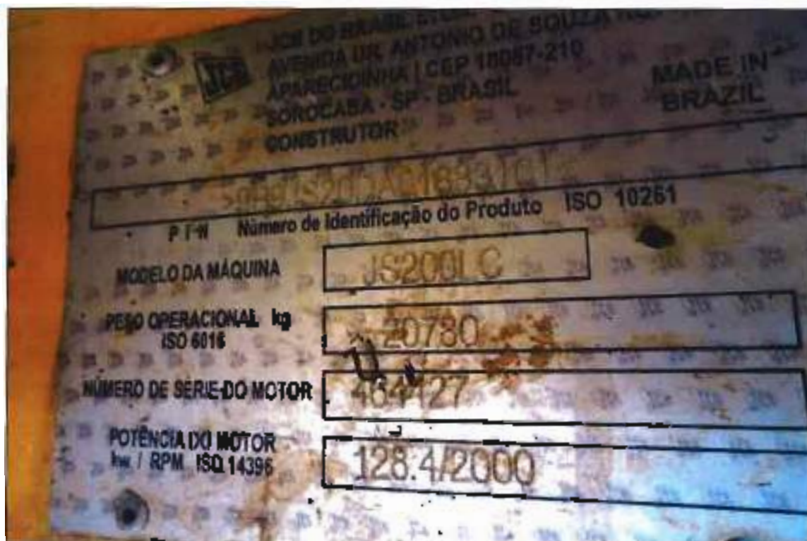
ITEM 2,49] - VISTA DA PLACA DE IDENTIFICAÇÃO DA ESCAVADEIRA HIDRAULICA MARÇA: JCB MODELO: JS200LC CHASSI/SERIE: 9B9JS20DA01633101 PLACA: SEM PLACA
