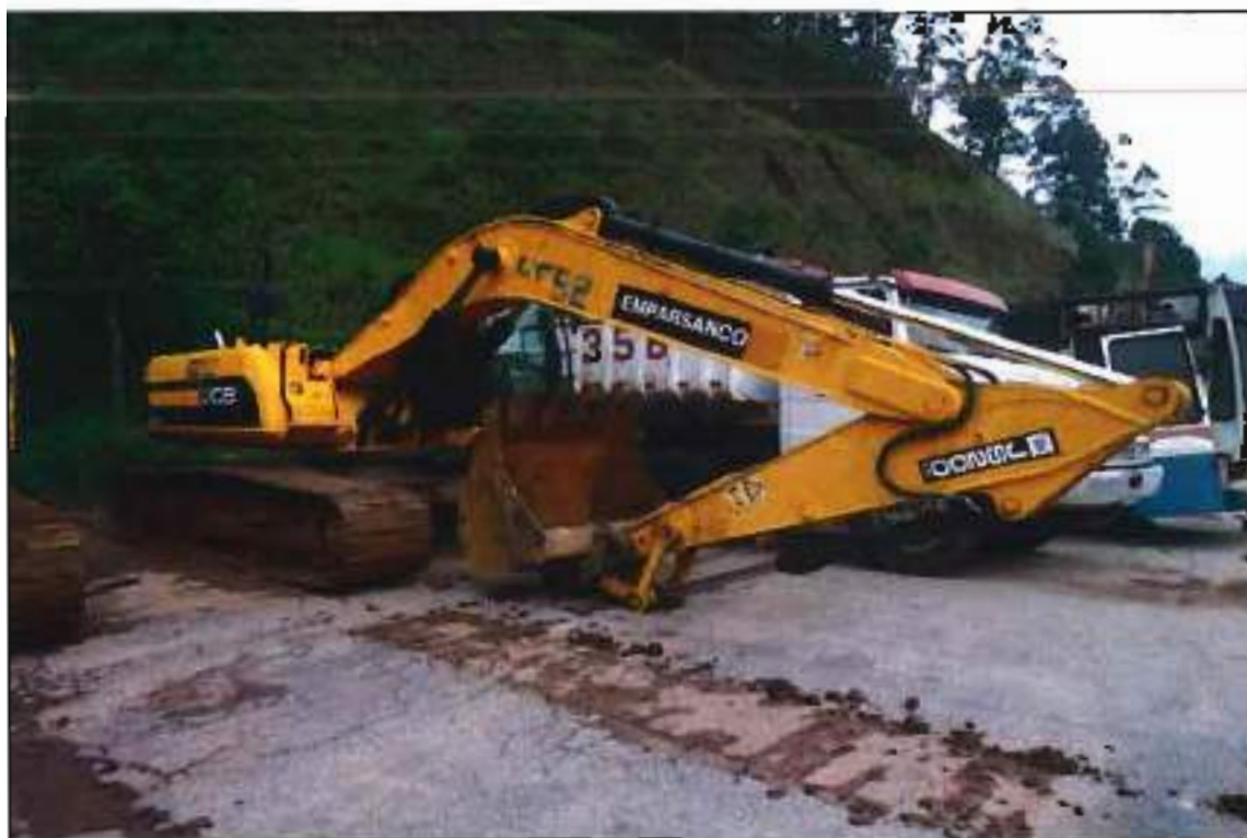
ITEM 2.091 – VISTA DA ESCAVADEIRA HIDRAULICA MARCA: JCB MODELO: JS200LC CHASSI:SERIE: 9B9JS200A01633101 PLACA: SEM PLACA
