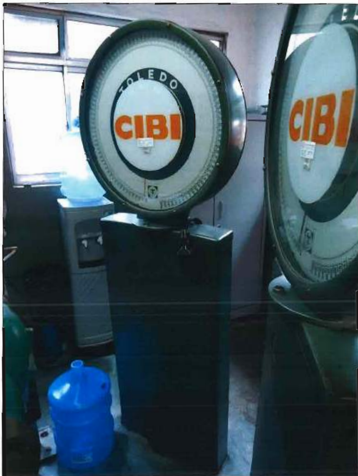
ITEM 1,001 - VISTA DA BALANÇA MARCA: TOLEDO MODELO: 2191 CAP: 5000 KG SÉRIE: 81692 PT DA LINHA CENTRAL DE CONCRETO
