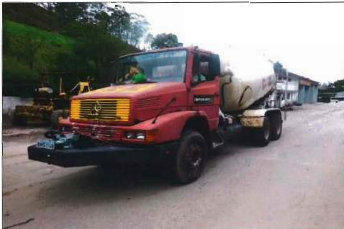
ITEM 2,004- VISTA DO CAMINHÃO BETONEIRA MARCA: MERCEDEZ-BENZ MODELO: LB 2325 CHASSI/SERIE: 9BM386387MB919959 PLACA: BMS - 0148
