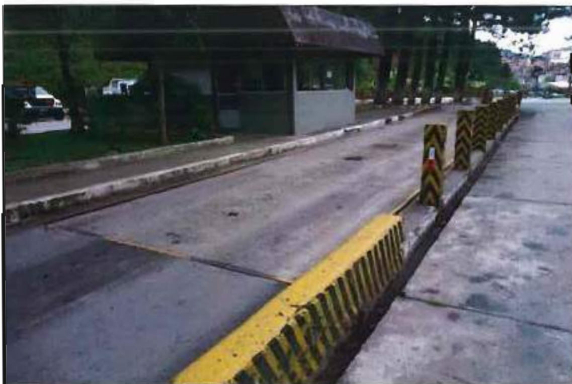
ITEM 1,005 – VISTA DA VISTA BALANÇA PARA PESAGEM DE CAMINHÃO MARCA: B&L BALANÇAS MODELO: 3.601711 CAPACIDADE: 8 TON DIMENSAO: 17 X 3 M SERIE: 13750
