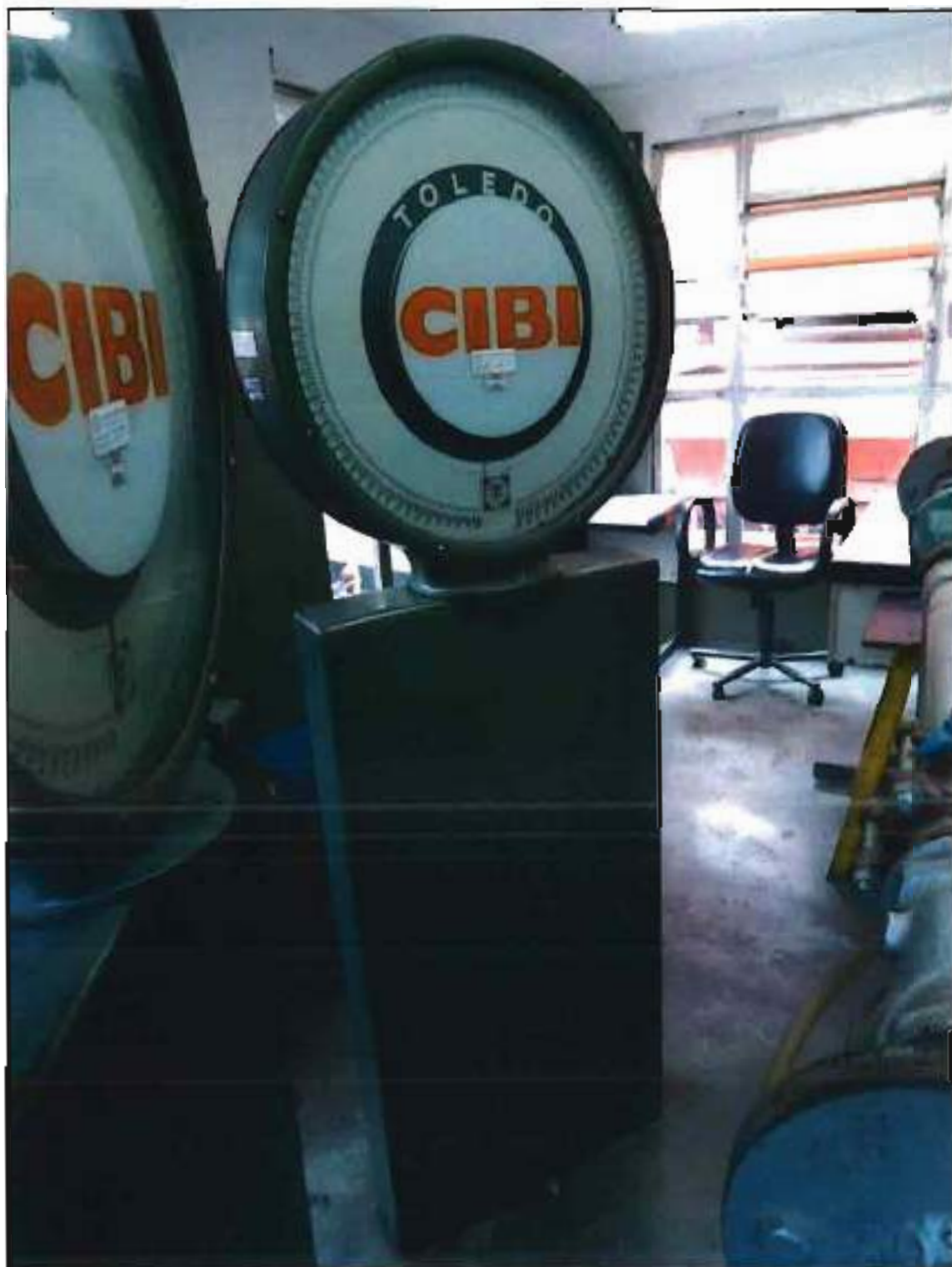
ITEM 1,001 - VISTA DA BALANÇA MARCA: TOLEDO MODELO: 219L CAP: 20000 KG SÉRIE: 81253 VS DA LINHA CENTRAL DE CONCRETO
