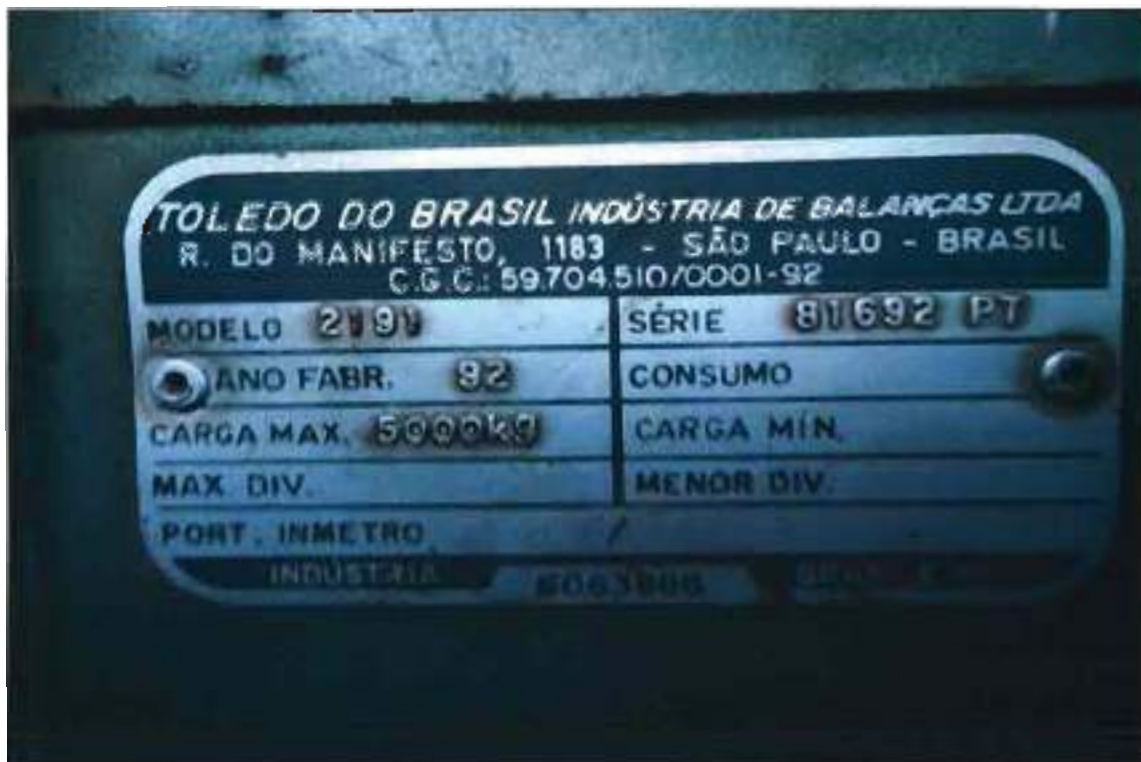
ITEM 1,001 - VISTA DA PLACA DE IDENTIFICAÇÃO DA BALANÇA MARCA: TOLEDO MODELO: 219I CAP: 5000 KG SÉRIE: 81692 PT DA LINHA CENTRAL DE CONCRETO
