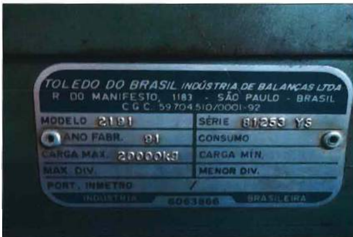
ITEM 1,001 - VISTA DA PLACA DE IDENTIFICAÇÃO DA BALANÇA MARCA: TOLEDO MODELO: 2191 CAP: 20000 KG SÉRIE: 81253 YS DA LINHA CENTRAL DE CONCRETO
