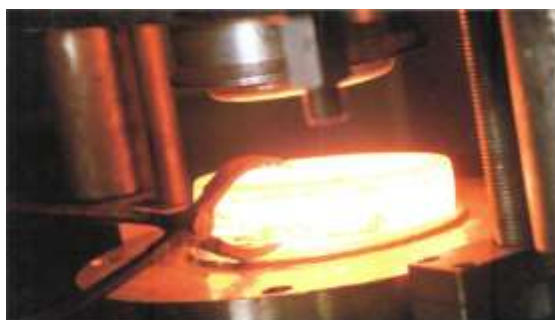
Processo de forjamento a quente
